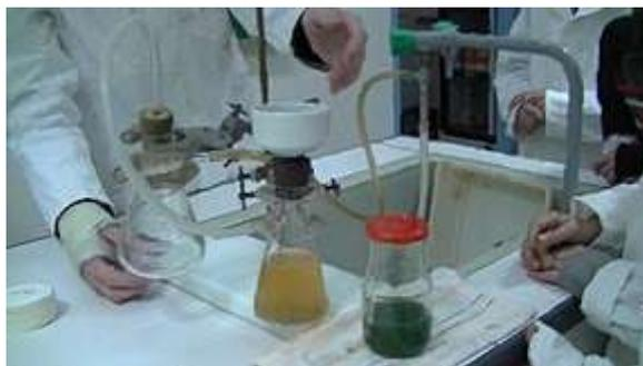
**N.B :** la fiole à vide doit toujours être maintenue par une pince fixée à un support par une noix.
